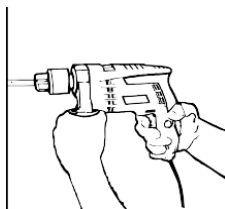
使用衝擊電鑽在牆上打孔
