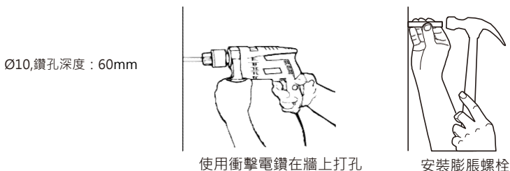
圖 4.9 膨脹螺栓使用
