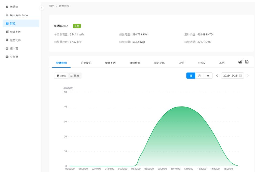
點擊日/月/年來查看發電情況，同時，您也可以點擊日期，切換到想要查看的日/月/年。另外，您還可以點擊下載圖示按鈕，下載變流器的發電及電網端的資訊。
