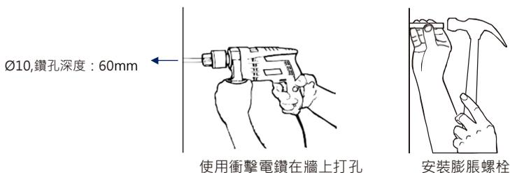
圖 4.12 打孔和安裝膨脹螺栓 (單位: mm)
