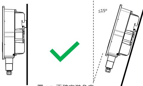
圖 4.5 正確安裝角度
