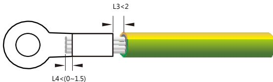
圖 5.2 壓接環型端子(單位 : mm)
