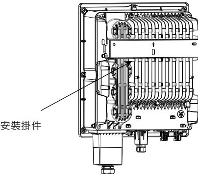
圖 2.5 PV-10000S-U/PV-15000S-U 機殼背面
