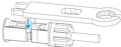
圖 9.1 拆卸直流輸入連接器
