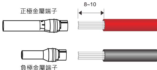
圖 5.8 直流線纜剝去絕緣層(單位 : mm)
