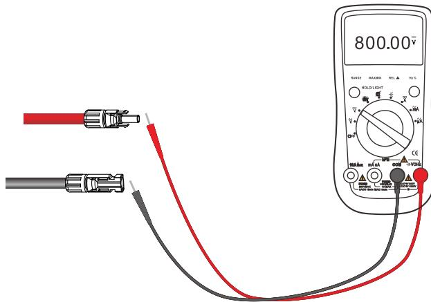
圖 5.12 檢查太陽能模組電壓
