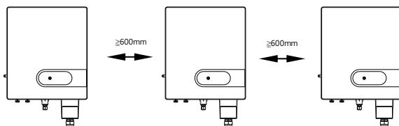
圖 4.4 一字型安裝 (單位 : mm )
