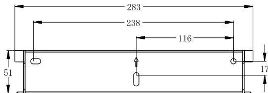
圖 4.7 附件包壁掛支架尺寸圖(單位 : mm)
