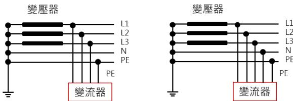
圖 2.2 本系列變流器適用電網系統
