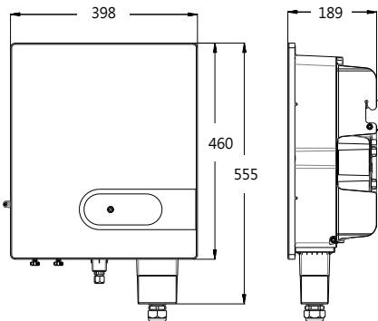
圖 2.3 PV-10000S-U/PV-15000S-U 主機殼尺寸圖 (單位 : mm)
