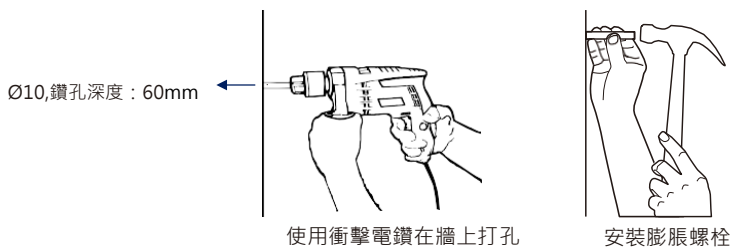
圖 4.12 打孔和安裝膨脹螺栓 (單位: mm)
