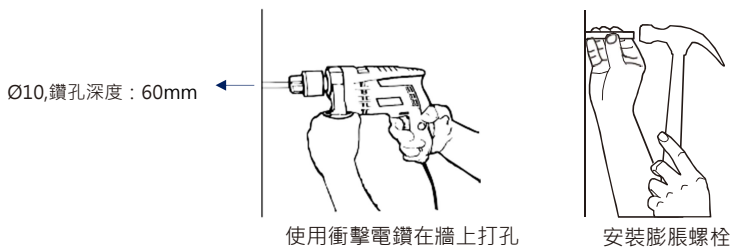
圖 4.12 打孔和安裝膨脹螺栓 (單位: mm)
