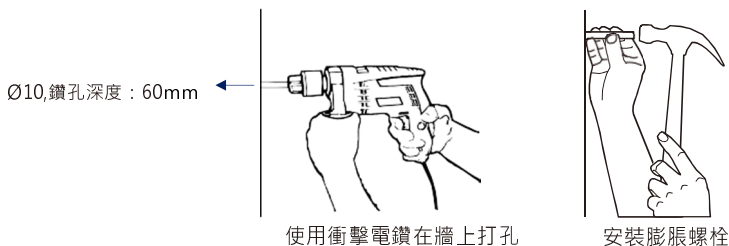
圖 4.12 打孔和安裝膨脹螺栓（單位：mm）
